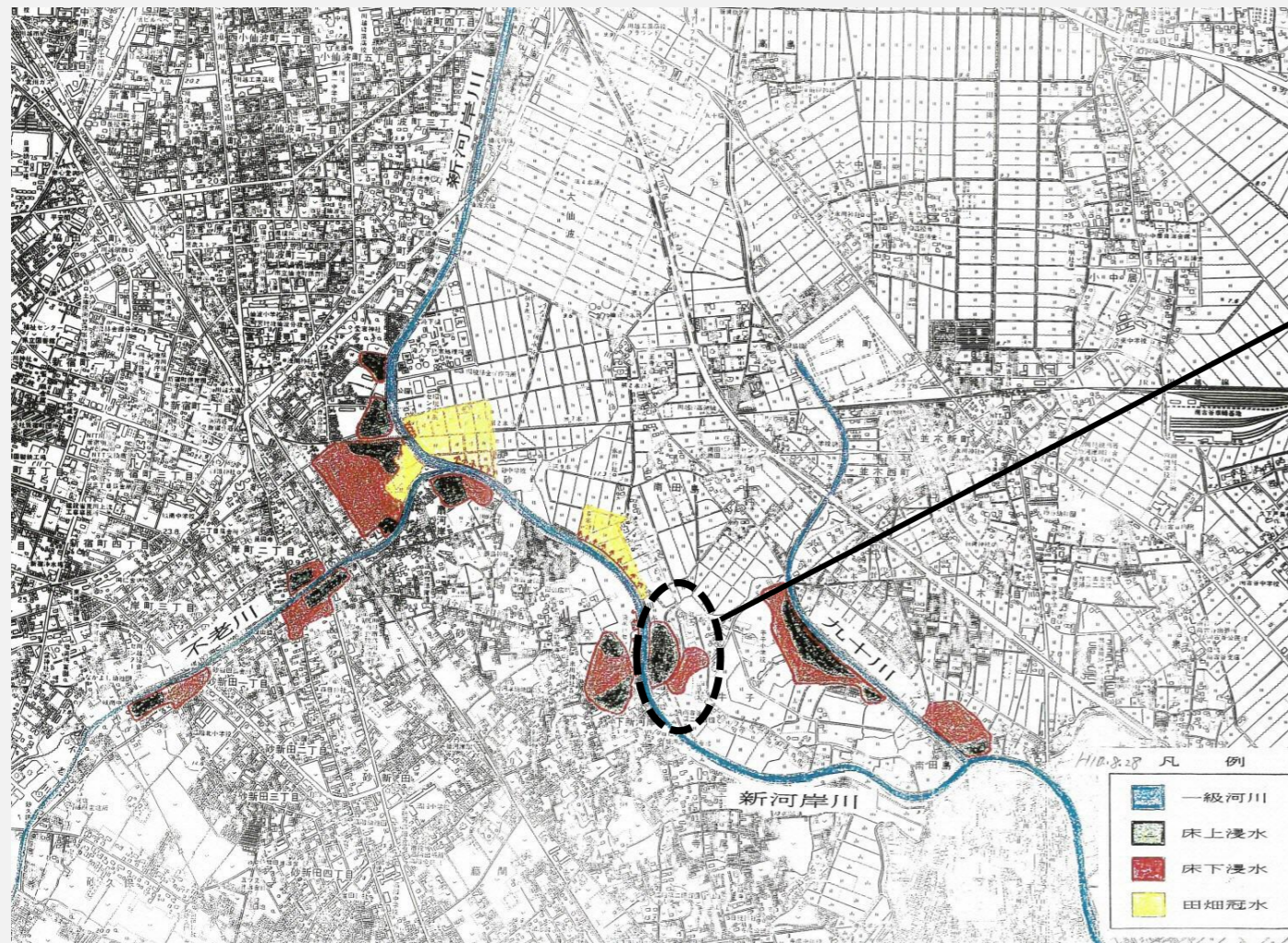
新河岸川・不老川・九十川からの越水による被害状況 (川越市作成資料)
