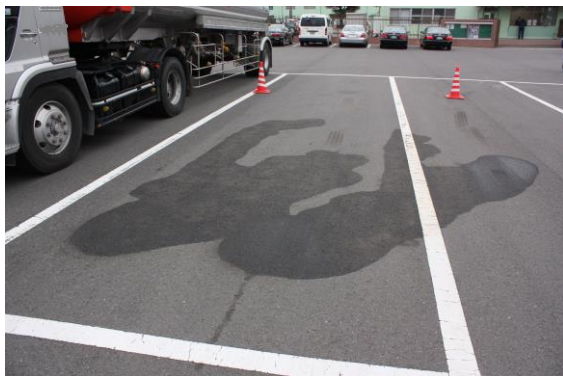
マンホールの固定が不完全であったため発生した流出事故の例
