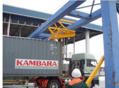
トレーラー積載コンテナの雪落しに「スノードロッパー」
