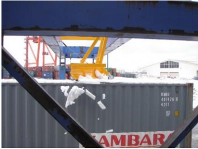
トレーラー積載コンテナの雪落しに「スノードロッパー」
