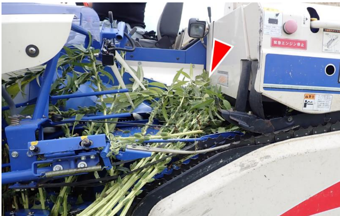
図 9-6 無分枝型品種の搬送部-脱穀部間での詰まり（赤矢頭部分）
