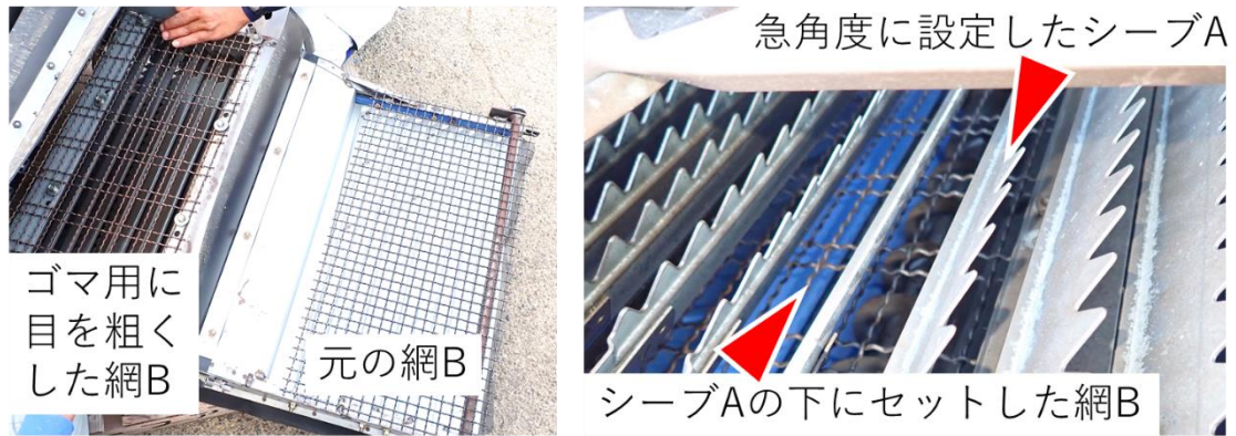
図 9-4 自脱型コンバインの網目とシーブの変更
