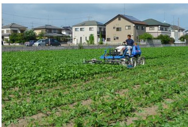
大豆摘心機による作業の様子 1 時間に 90a 程度の 面積の作業ができます。
