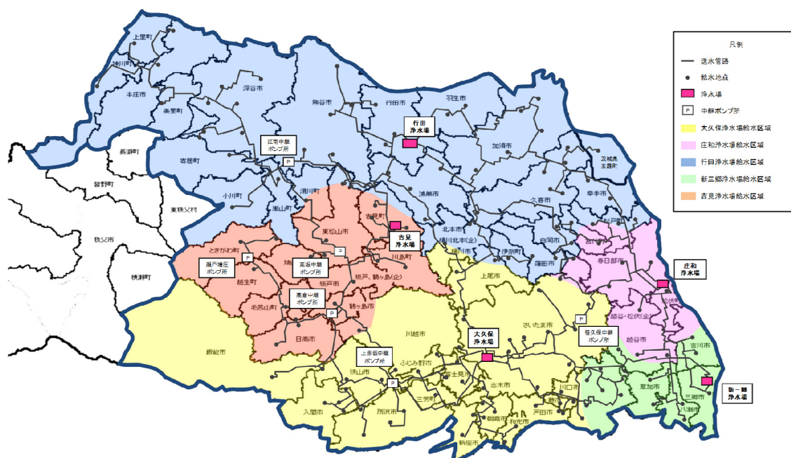
図1. 1 水道用水供給事業5浄水場の位置と給水区域 (各浄水場の給水区域は水運用状況によって変わるため概略として示す)
