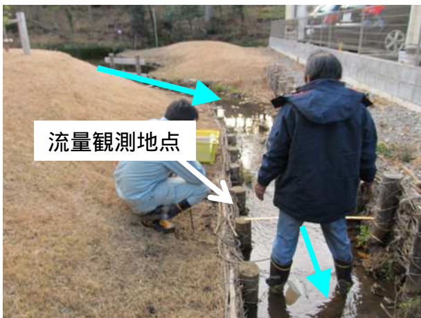
写真 池から水路へ流れる部分で流量を測定
