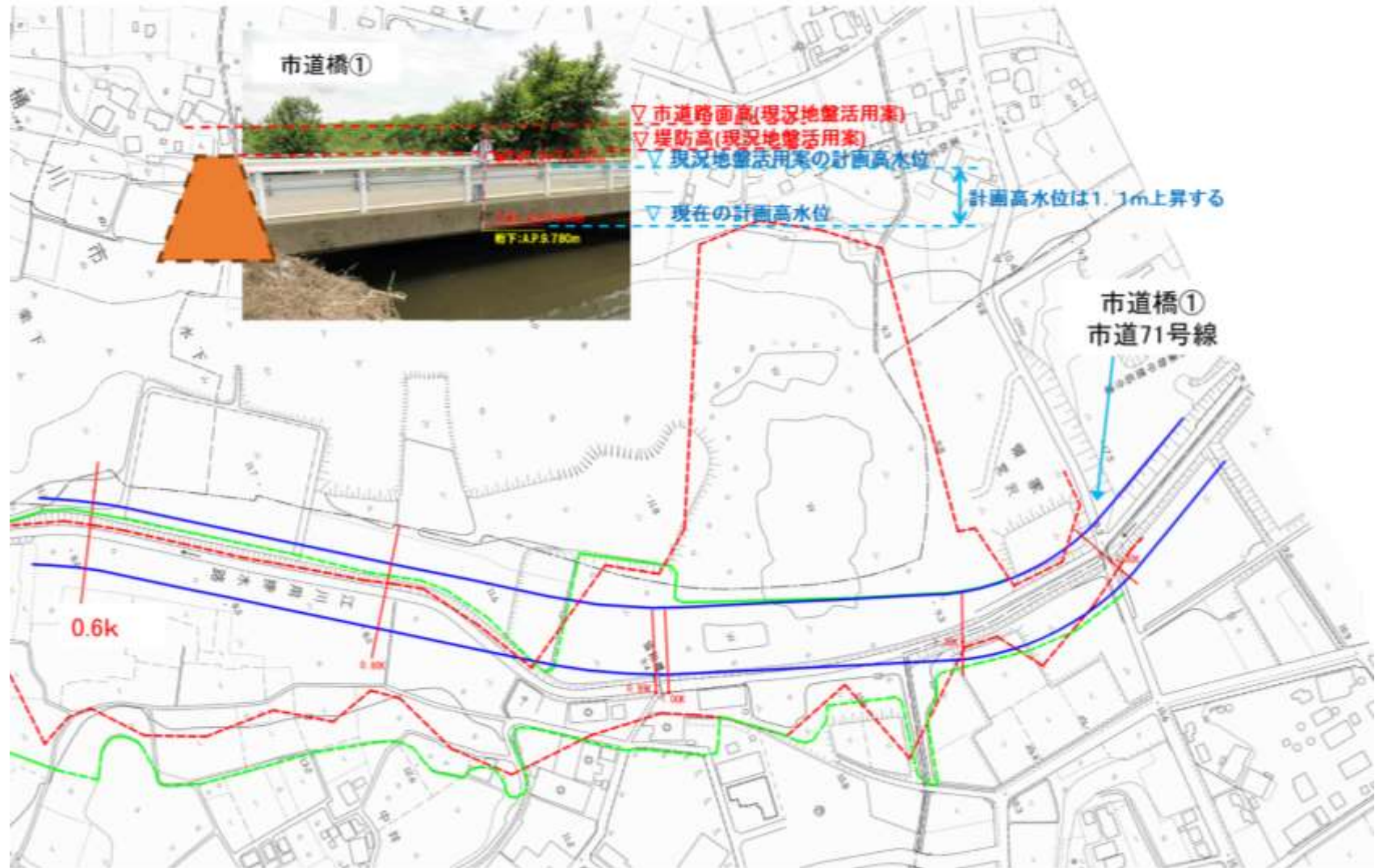
図一〇市道71号線橋梁の水位上昇予測状況
