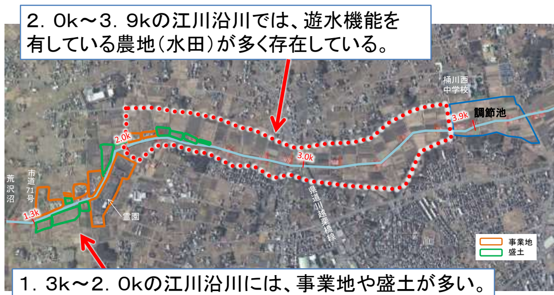
図－11 江川沿川の土地利用の状況と遊水機能を有している農地の状況
