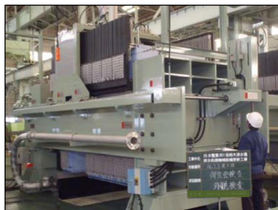
機械設備（脱水機）
