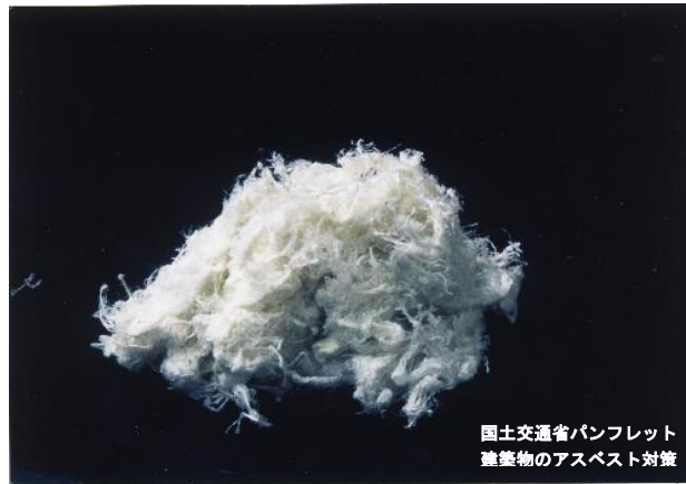
白石綿（クリソタイル）
