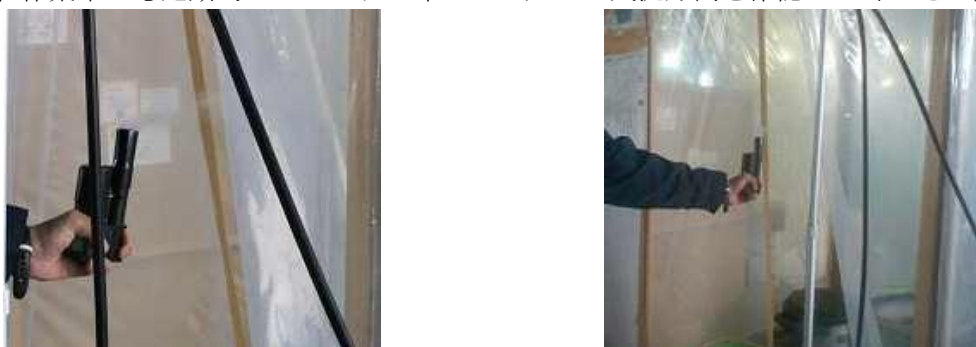
図 4-12 セキュリティゾーンの入口の気流方向の確認（参考：出典 1 P218）
