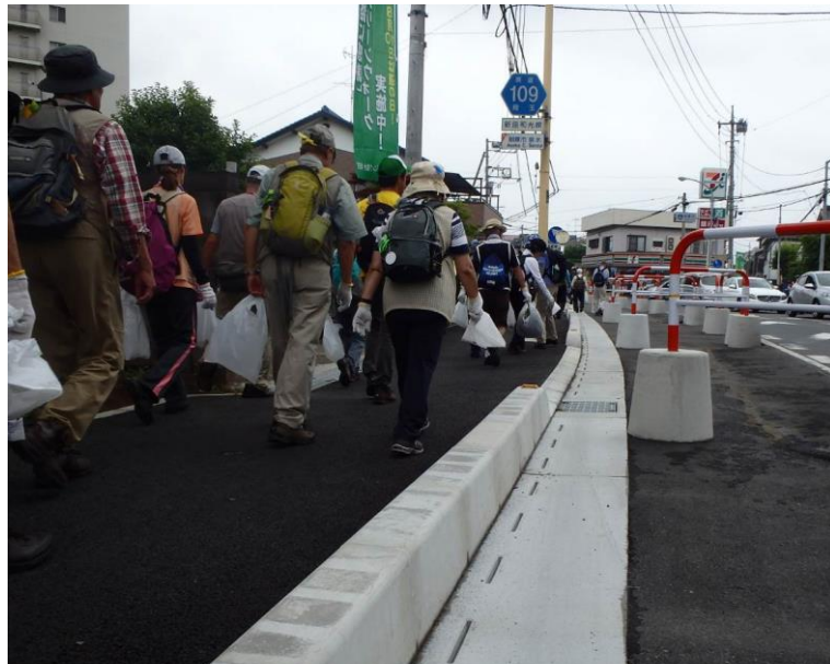
◆県道新座和光線。右上は集水性に優れたスリット式の側溝です。溝がないのでゴミも拾いやすいです。
