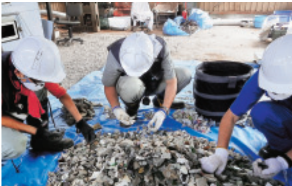
写真4-18-3 アスベスト含有建材の選別手法確立と再生砕石の安全性評価に関する研究
