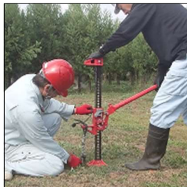
図3 考案した引き抜き方法（左から ファームジャッキ・支柱、ファームジャッキ・アンカー、引き抜き棒・アンカー）
