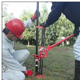
図3 考案した引き抜き方法（左から ファームジャッキ・支柱、ファームジャッキ・アンカー、引き抜き棒・アンカー）
