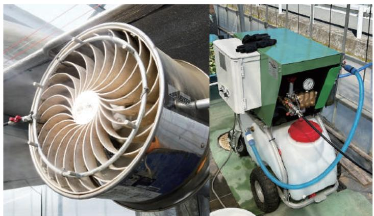
循環扇に設置されたリングノズルとポンプユニット
