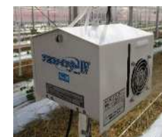
統合環境制御装置
