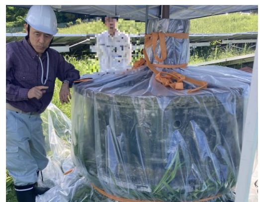
さまざまなタイプのガス抜き管におけるガス放出量調査の様子
