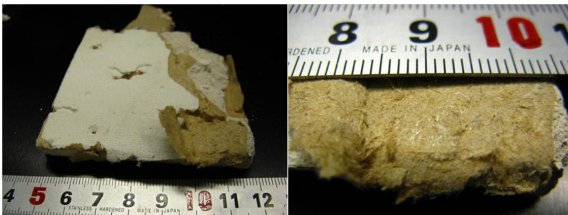
図 7.16.9b 石膏ボード B（厚さ 9.3mm；石綿含有）
