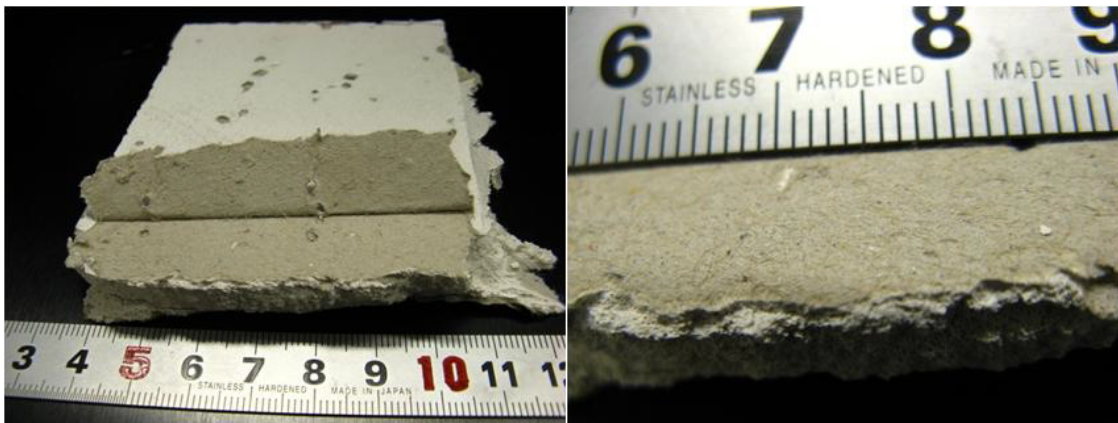
図 7.16.9a 石膏ボード A（厚さ 9.3mm；石綿含有無し）
