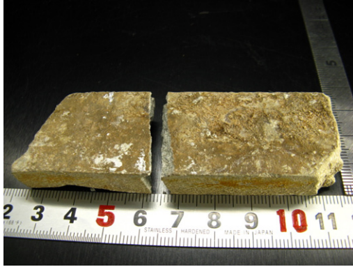
図 7.16.5a スレート板表面写真
