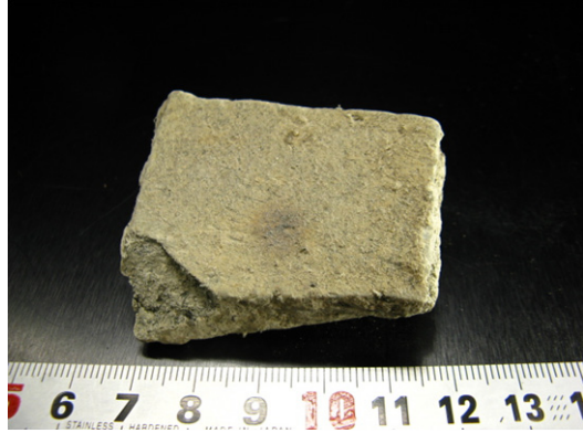
図 7.16.8b スレート板（表面）
