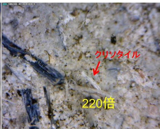
図 7.16.1f USB デジタル顕微鏡（220倍）
