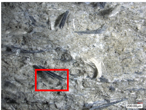
図 6.1a 石綿含有建材（クォンタライト、クリソタイル）
