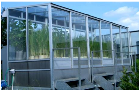
図1 オープントップチャンバーによる模擬環境実験
