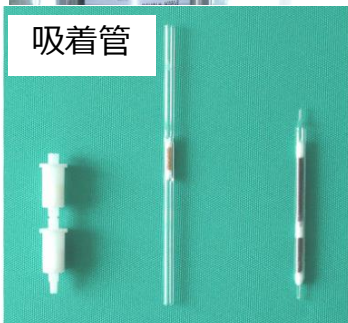
図 大気中の有害物質を採取するための装置と吸着管
