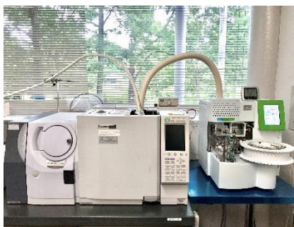
図1 加熱脱着-GCMS分析装置 (VOCの分析に使用)
