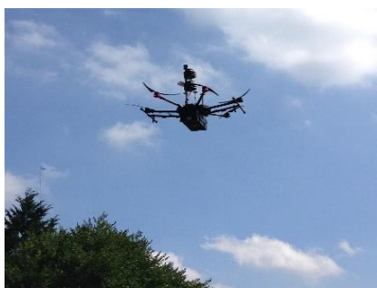
図3 ドローンをを用いた高度1,000mまでの大気調査 (東秩父でのオゾン調査)
