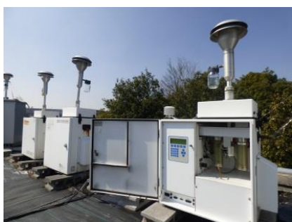
図2 センターに設置しているPM 2.5 サンプラー
