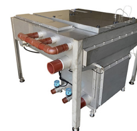
▲排水中の油脂を回収・資源化する装置
