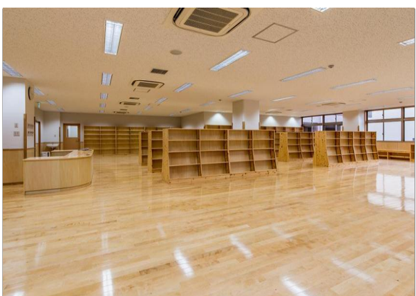
写真⑤ 新校舎内観（図書室） 床・腰壁に木材を使用し、書架・カウンターに埼 玉県産ヒノキ燻煙乾燥材を使用。
