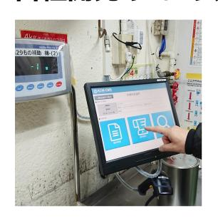
塗装管理のノウハウを独自開発したIoTシステムに投入。塗料調合量の最適値を見える化。無駄な塗料や、調合間違えなどで廃棄する塗料を無くす。検査工程から塗装現場へのフィードバックを敏速に行い、不良率の低減を実現!
