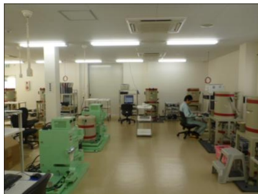
写真2 計測室内に設置されたゲルマニウム半導体検出器
