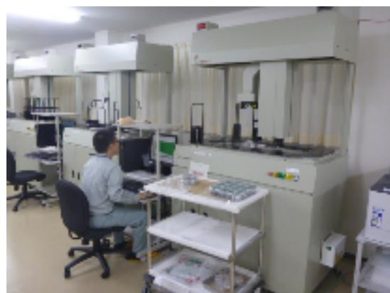
写真2 ゲルマニウム半導体検出器による分析
