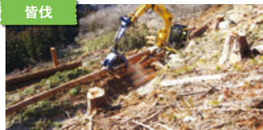
森林を伐採し、丸太を必要な規格に切り分けている様子
