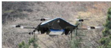
機体「AirTruck」 1回最大4kgを運搬
