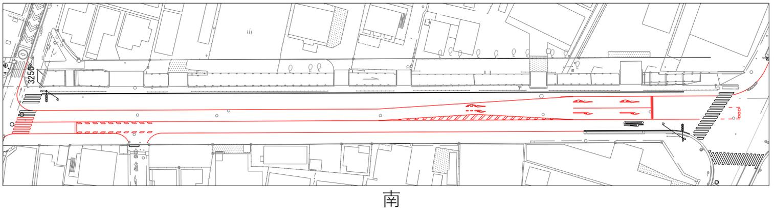
北側水路工事スペース確保のため、**赤矢印**方向に約1車線分車線を振り替えます。
