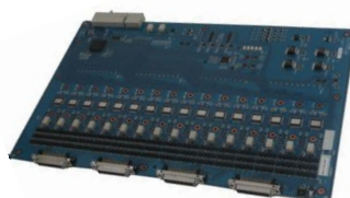
〈計測電源装置〉
