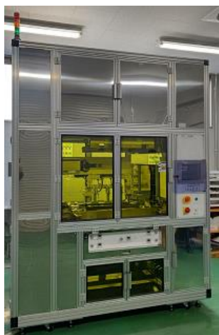
開発した精密両面塗工装置
