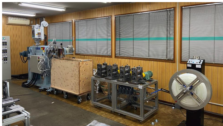
図1 草刈用コード製造装置の概要
