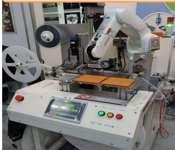
自動ネジ締め実証装置(自主開発)
