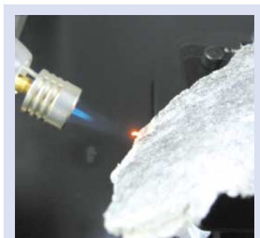
断面加熱によるアスベストの判別
