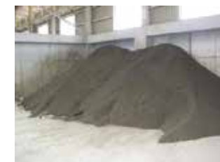
浄水発生土 (場内保管時)
