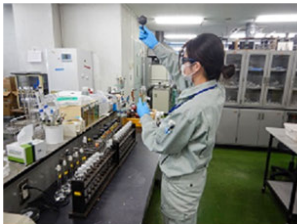
写真 - 2 全リン（リンを含む化合物総体）試験の様子（下水道公社 HP から引用）
