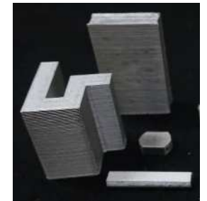
図4 除去されたサポート
