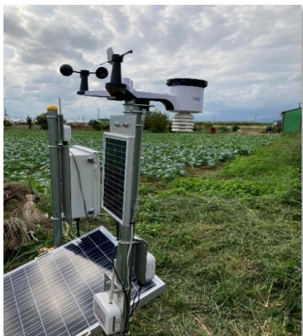
ほ場モニタリングシステム
