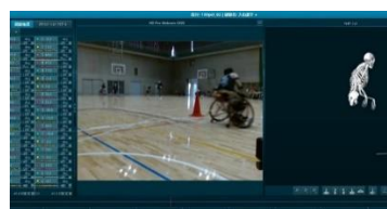
図2 回転時のフレーム歪みの計測の様子
