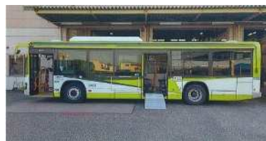
ノンステップバス 床面を超低床構造にした乗降しやすいバス
