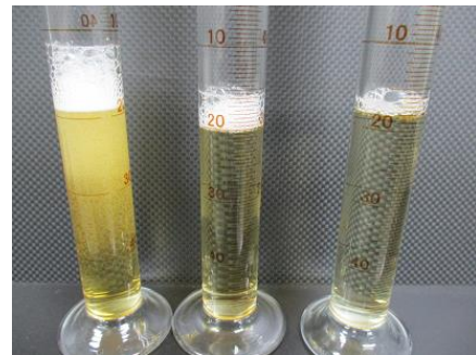
図 3 発泡酒と KOH-aq を混合した様子 (左から、混合比 8:2、5:5、2:8)
