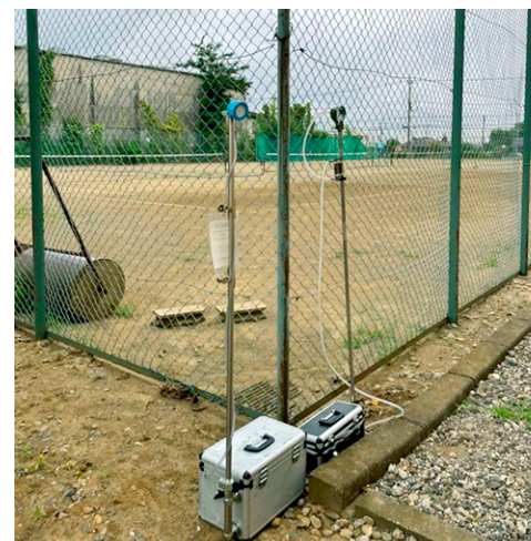
写真13-3 環境大気中の石綿濃度の測定
