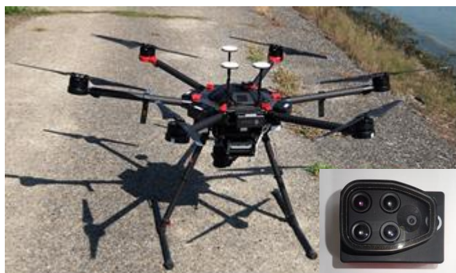
写真2 空撮に用いるドローンとマルチスペクトルカメラ
