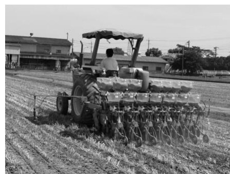
図1 不耕起播種機による播種
