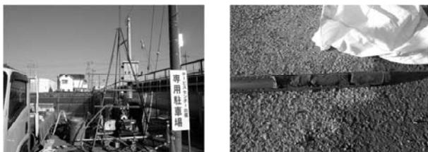
図 掘削風景と採取した地質試料
