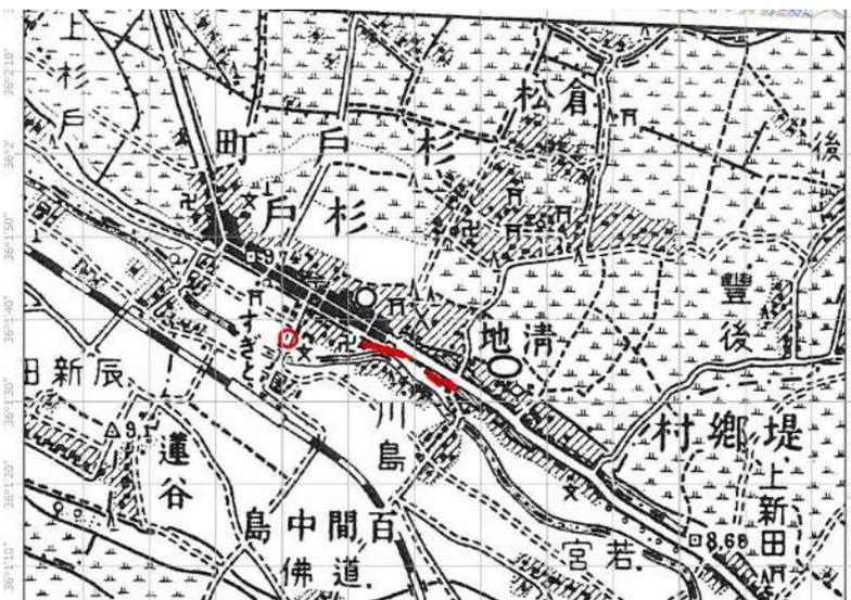
地質調査所によると、古利根川の北岸の畑、宅地、道路で川に並行な地割れ群ができた。その中でも杉戸小学校から杉戸駅にかけて大きな地割れや陥落地帯ができ、校舎などが傾斜・倒壊した。地割れや陥落地帯の幅は、最大5.4mもあり、多量の水、砂、浮石を噴出し、校庭が傾斜・倒壊した。
