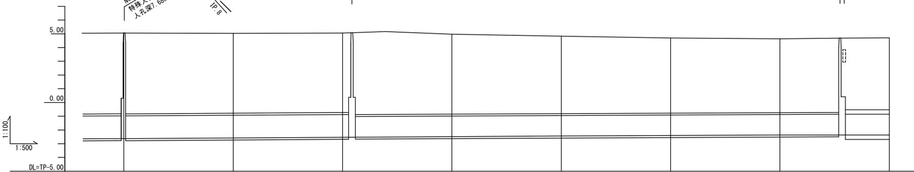
● 1650 1.3‰ 83.24m 推進工法 鉄筋コンクリート管
