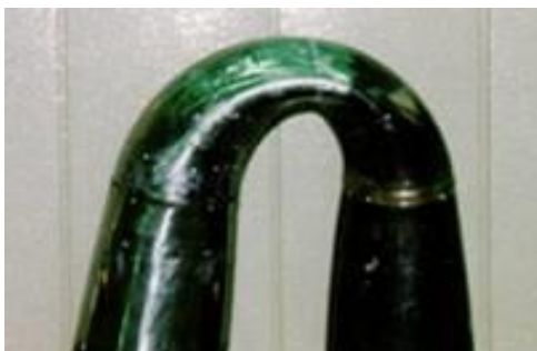
中圧ガス導管の曲げ試験
