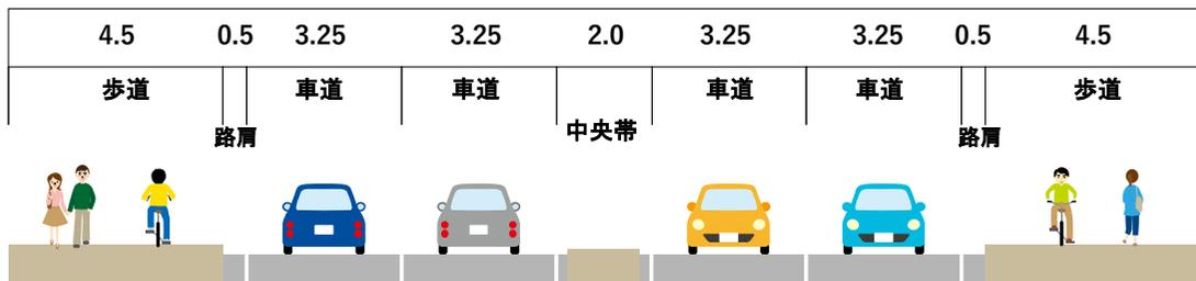
道路の構造につきましては、「埼玉県が管理する県道の構造等の基準を定める条例」により、道路幅員や車線数などを決定します。浦和野田線は、4車線の車道と両側に歩道を設置し、標準幅員が25mの道路となります。
